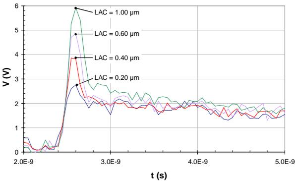
**Figure 7:** The corresponding voltage waveforms for the NWell STI diode LAC variations (VF TLP 10 ns/ 100 ps) ( $V_{\text{pulse}} = 8\text{ V}$ ).
